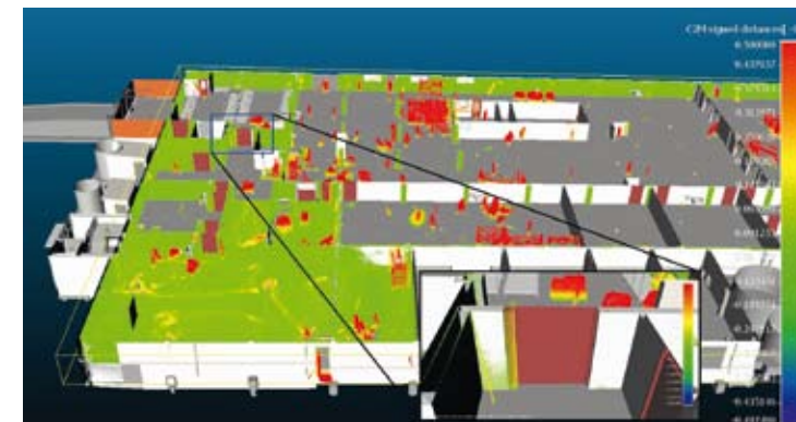
5. attēls. BIM modeļa salīdzinājums ar punktu mākonī programmā CloudCompare .
